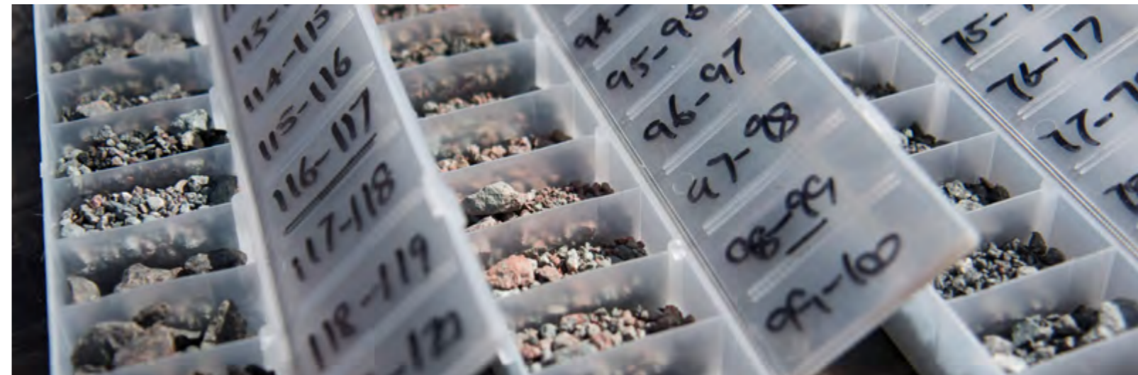
TEILPROBEN EINER EXPLORATIONSBOHRUNG VON HAMMER METALS, AUSTRALIEN
